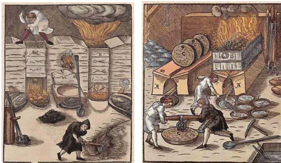
Obr. 31 A - Šachtová pec; B – Vycezdování (Vaněk – Velebil, 2007)
